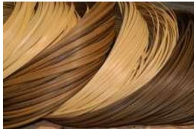
**Gambar 1. Bahan Rotan setengah jadi yang berupa batangan dengan warna dan tekstur yang mirip dengan rotan alami**
